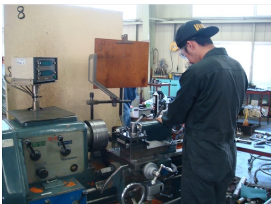
シャフトの加工(汎用旋盤)
