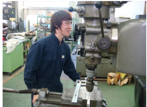
正確な位置での加工(ドリルミラー)
