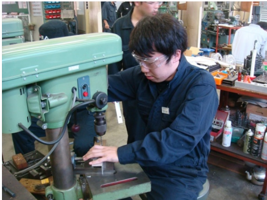
穴あけ作業(ボール盤)
